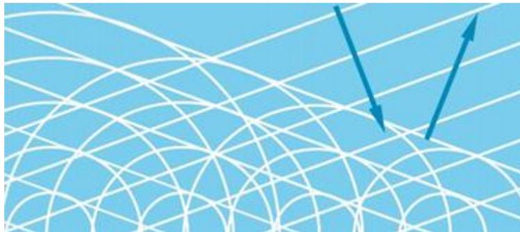
Bei der Reflexion eines Lichtstrahls an einer spiegelnden Fläche sind Einfallswinkel und Ausfallwinkel gleich groß ( $\theta_i = \theta_r$ ). Beim Übergang eines Lichtstrahls von einem Medium in ein anderes Medium mit unterschiedlicher optischer Dichte wird er hingegen an der Grenzfläche entsprechend des **Brechungsgesetzes von Snellius** ( $v_1$  und  $v_2$  bezeichnen die beiden Lichtgeschwindigkeiten.) gebrochen:  $\frac{\sin \theta_i}{v_1} = \frac{\sin \theta_r}{v_2}$
